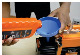
2 - Complete o óleo do cárter conforme capacidade especificada na tabela de Dados Técnicos, verificando pelo visor do nível. UTILIZE ÓLEO ISO VG46 SURYHA (80156.001)
