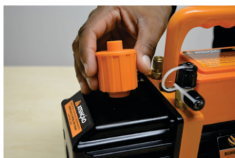
1 - Retire a tampa e insuflamento de ar do Carter de óleo;
