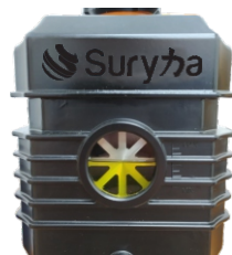
3 - Analise se o nível do óleo está entre a indicação mínima e máxima, localizada no meio do visor.
