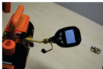
5 - A SURYHA recomenda a utilização de VACUÔMETRO DIGITAL (80150.065) , garantindo precisão no resultado
