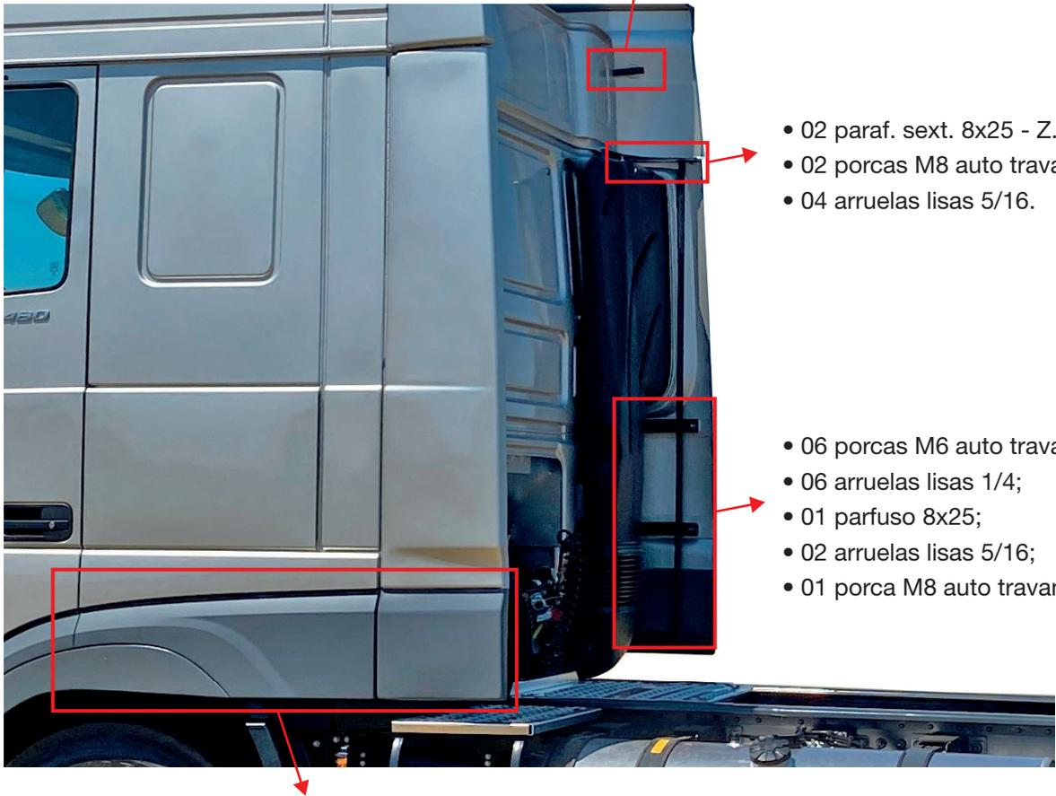
**OBSERVAR A REGULAGEM DO PARA-LAMA ORIGINAL COM A LATERAL INFERIOR. SE PRECISO, AFROUXAR O PARAFUSO ORIGINAL PARA ALINHAR CORRETAMENTE O PARA-LAMA COM A LATERAL.**
